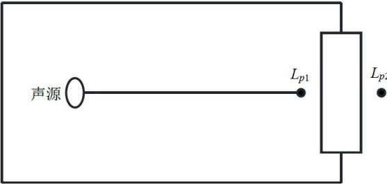
图 4.3-1 室内声源等效为室外声源图例
